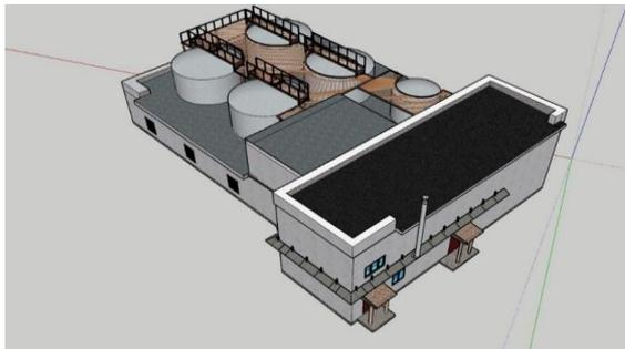
Внутренняя 3d модель здания с моделями оборудования (предвестник BIM-модели)
